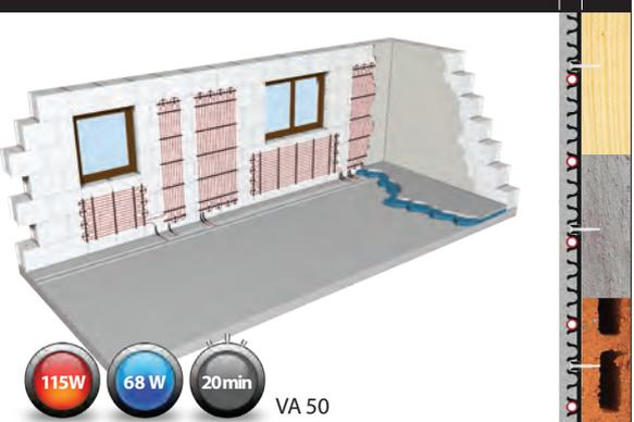
Vorgefertigte Heizregister integriert in 18 mm Putz
