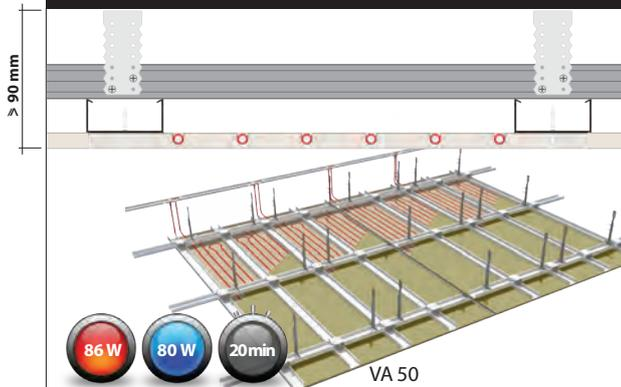
Heizregister in 15mm starken Gipsfaserplatten oder 12,5mm starken Gipskartonplatten integriert
