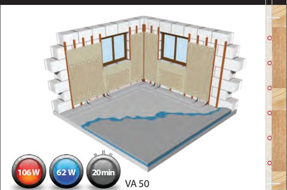
Heizregister in 15mm starken Gipsfaserplatten oder 12,5mm starken Gipskartonplatten integriert
