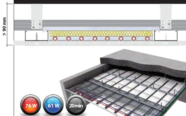
Heizregister zum Einhängen in die Struktur einer abgehängten Decke - geeignet für Akustikdecken
